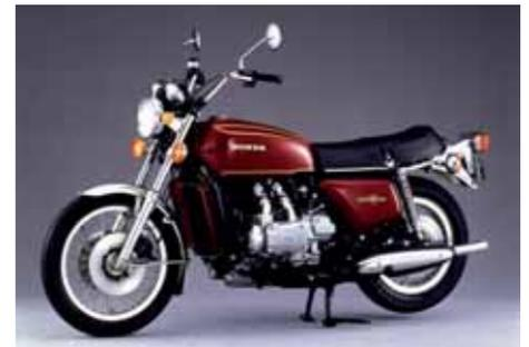
Die Gold Wing wurde ursprünglich von einem flüssigkeitsgekühlten Vierzylinder-Boxermotor mit 999 cm<sup>3</sup> Hubraum angetrieben.
