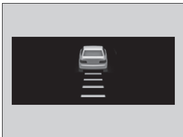
1 Erfassungsbereich der ACC mit Stauassistent: 120 m
