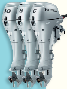
Ein Power Thrust Propeller (Schubpropeller) ist erhältlich, so dass diese Motoren auch für den Einsatz in schmalen Booten geeignet sind.
