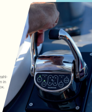
Intelligente Drehzahl-Synchronisation in einer Schaltbox.
