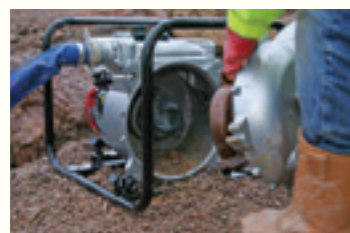
Der abnehmbare Inspektionsdeckel ermöglicht einen leichten Zugang
